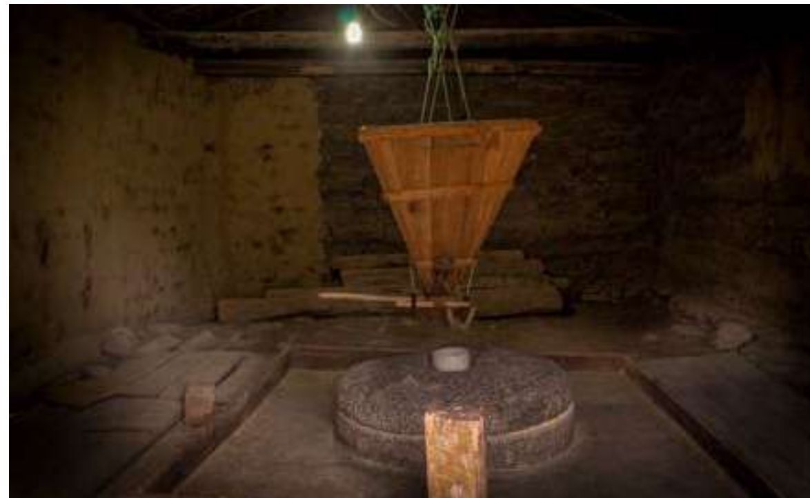
La tolva de madera y la piedra de moler en los Molinos de Charqui.
